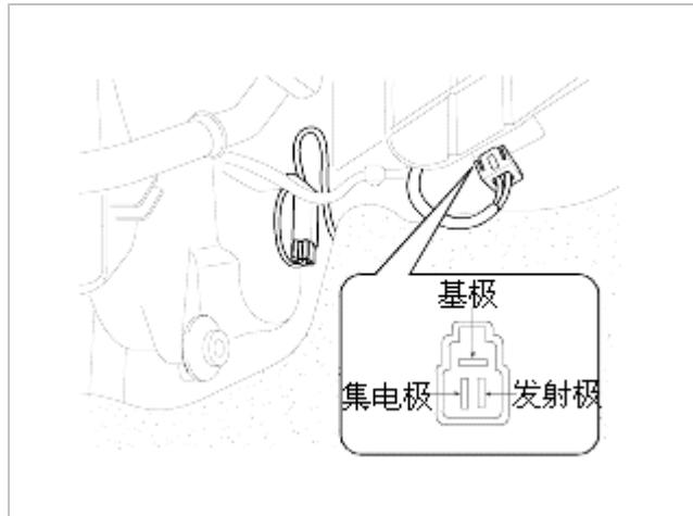
3. 拧下固定螺钉,拆卸大功率三极管。
